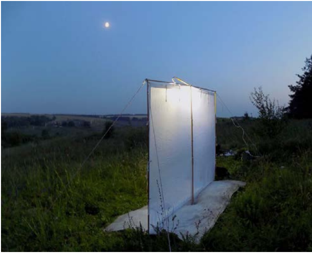
Рис. 1. Световая ловушка для ночного сбора чешуекрылых
